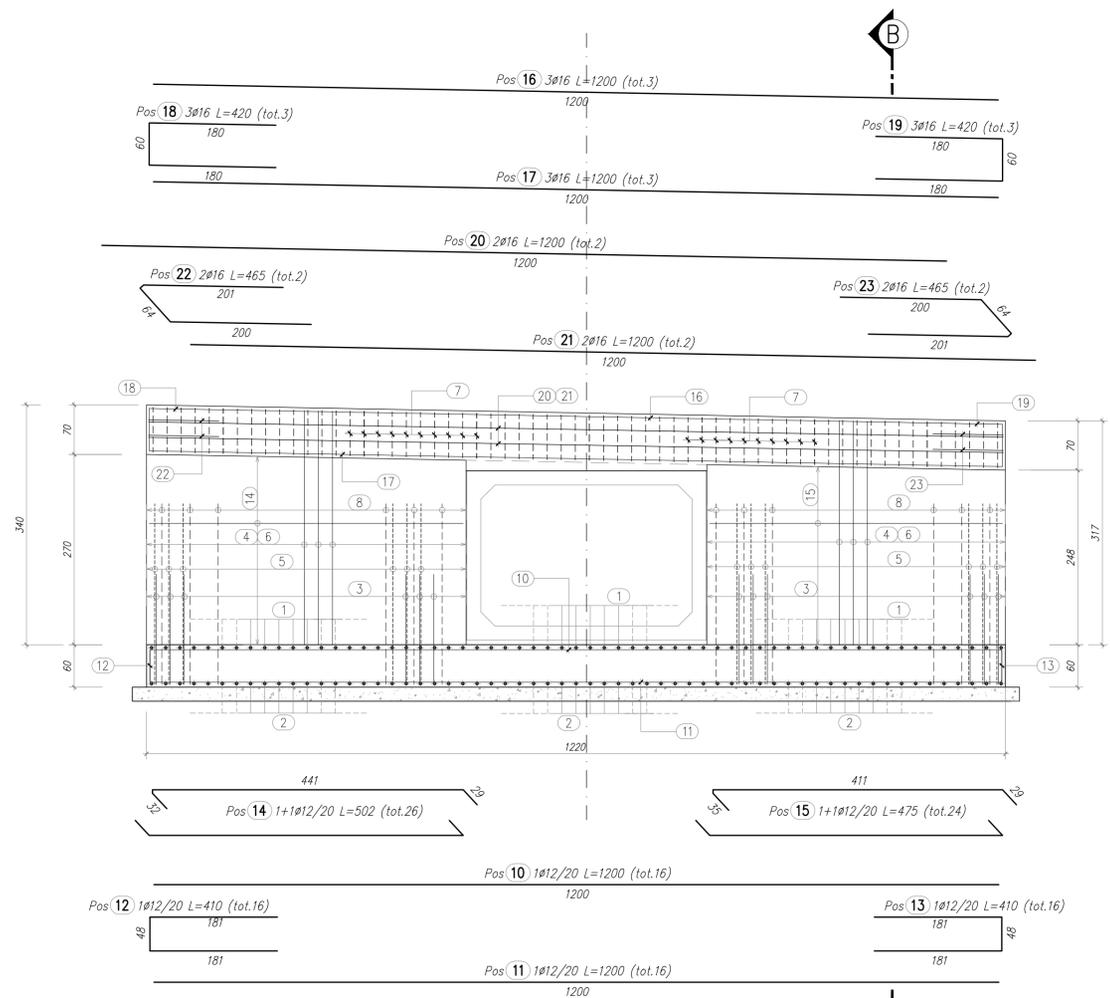
ARMATURA MURO IMBOCCO EST/OVEST
