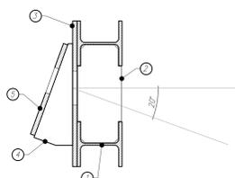
SPEZZIONI TUBO ACCIAIO PER CORREZIONE INCLINAZIONE ORIZZONTALE
