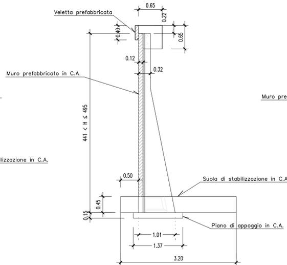
**SEZIONE "M" MURO PREFABBRICATO**
