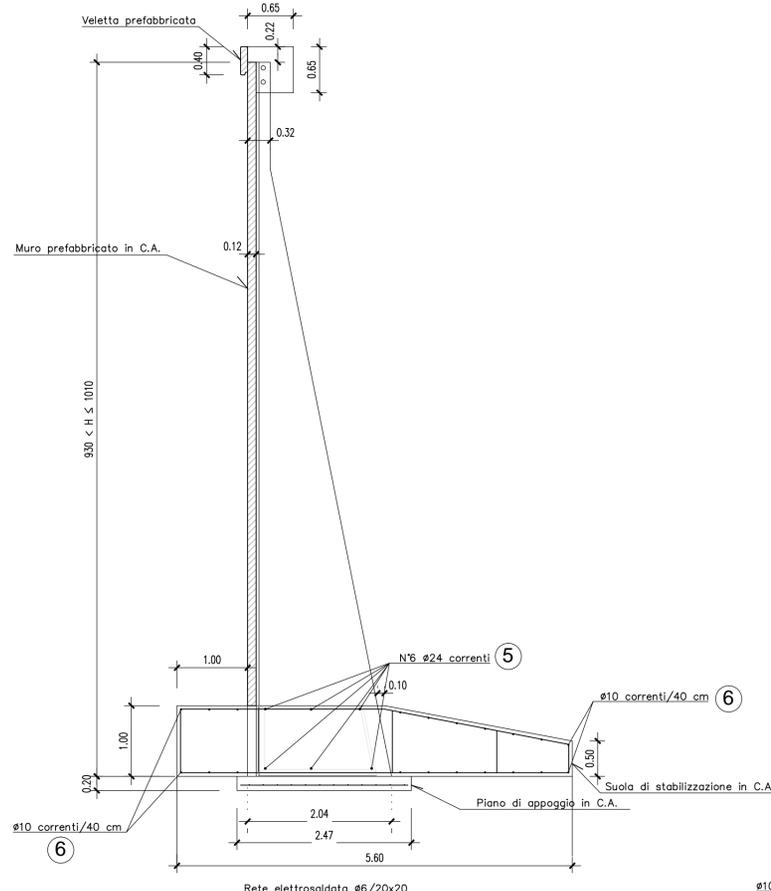
**SEZIONE "T" MURO PREFABBRICATO**
