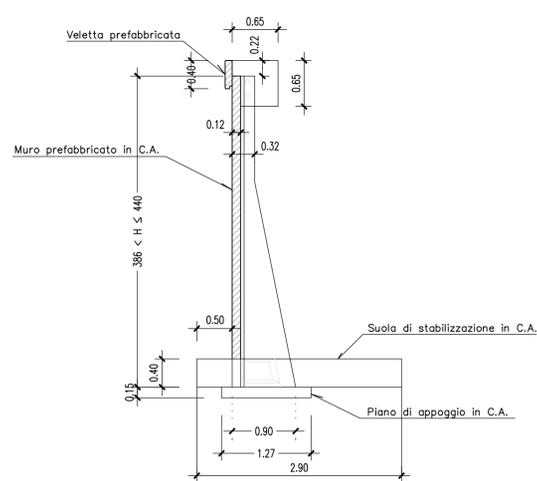
**SEZIONE "M" MURO PREFABBRICATO**
