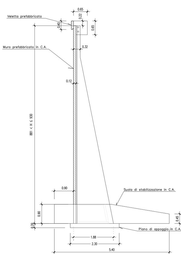
**SEZIONE "S" MURO PREFABBRICATO**
