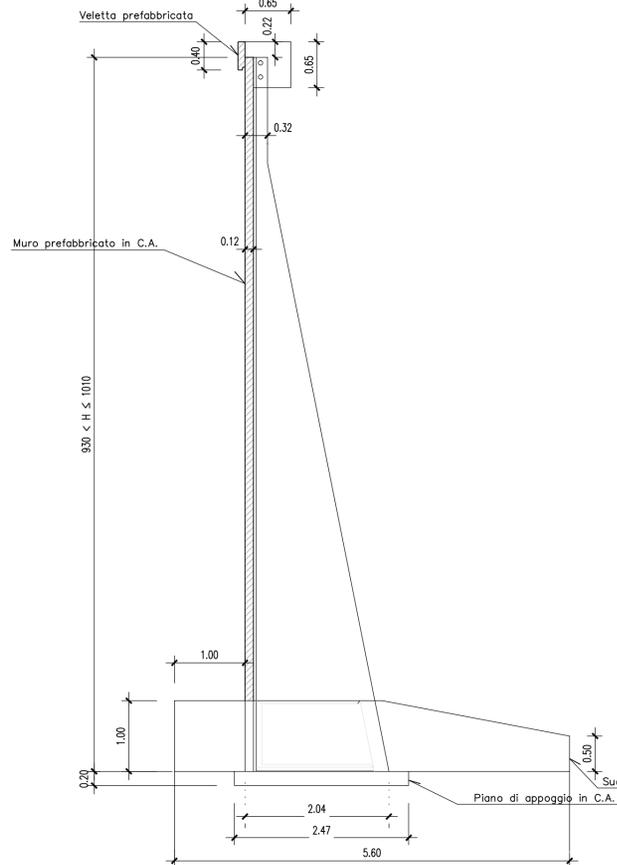
**SEZIONE "T" MURO PREFABBRICATO**
