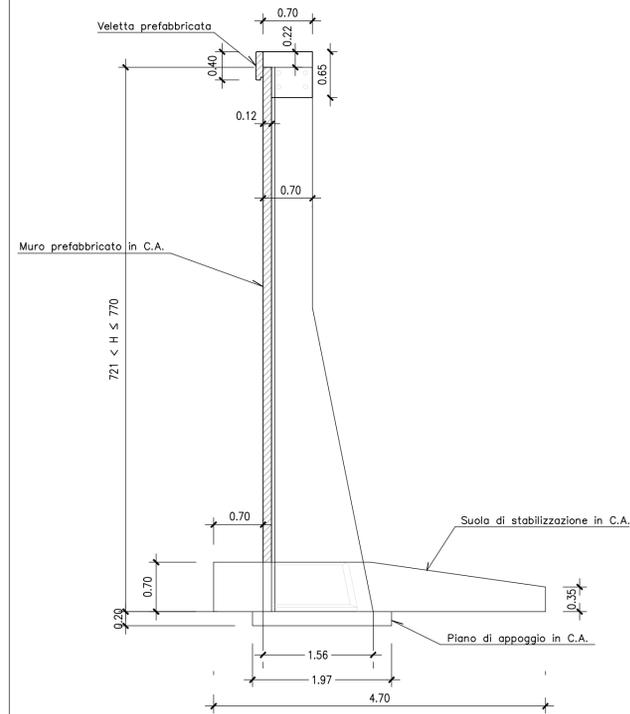
**SEZIONE " M " MURO PREFABBRICATO**
