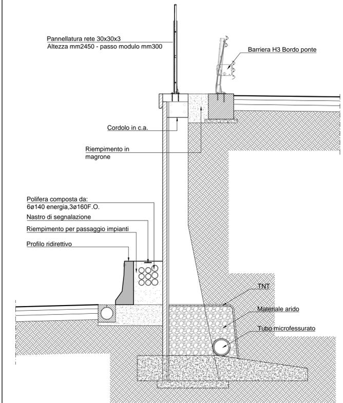
**SEZIONE " M1 " MURO PREFABBRICATO**
