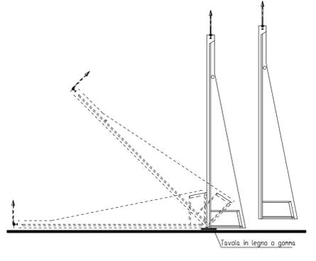
POSIZIONAMENTO DEL PREFABBRICATO PREVIO CONTROLLO DEGLI ALLINEAMENTI E DELLE QUOTE
