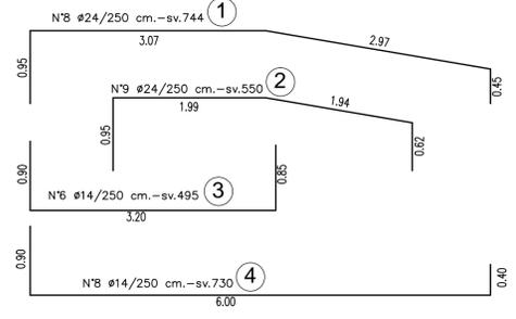
**SEZIONE "V" MURO PREFABBRICATO**
