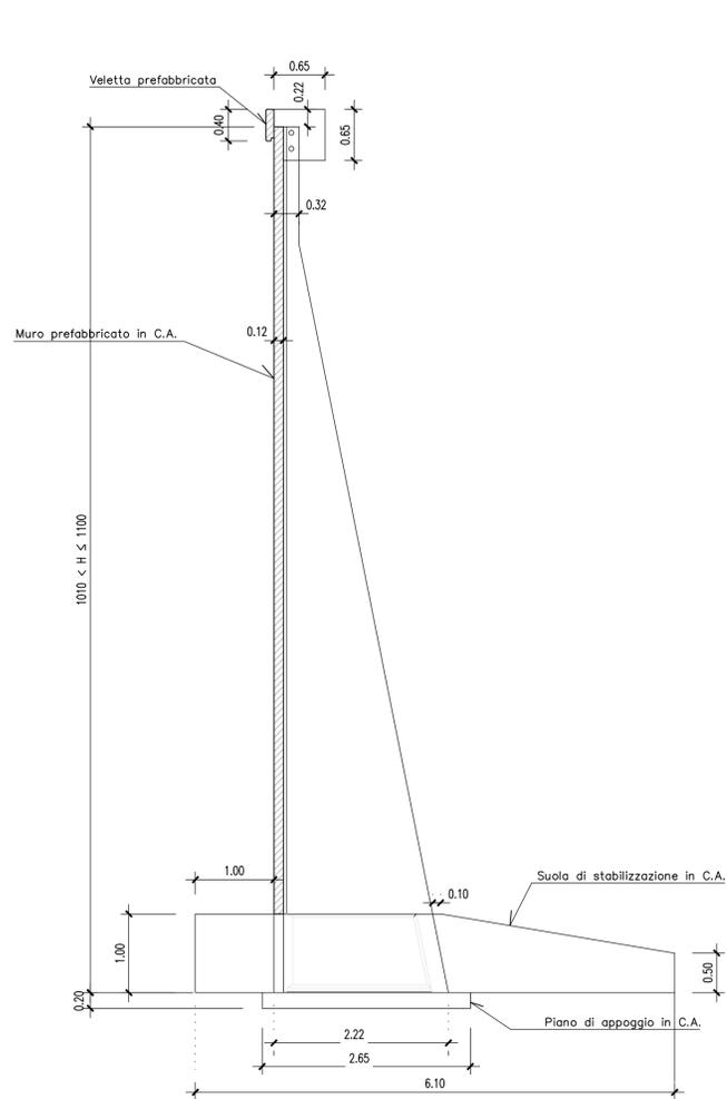
SEZIONE "V" MURO PREFABBRICATO
