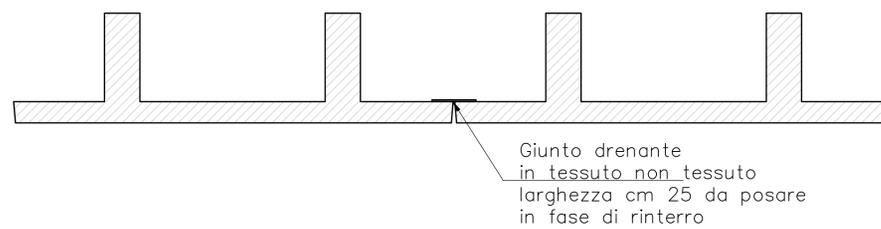
SCHEMA DI POSA SENZA IMPIEGO DI METALLERIA E VITERIA DI FISSAGGIO
