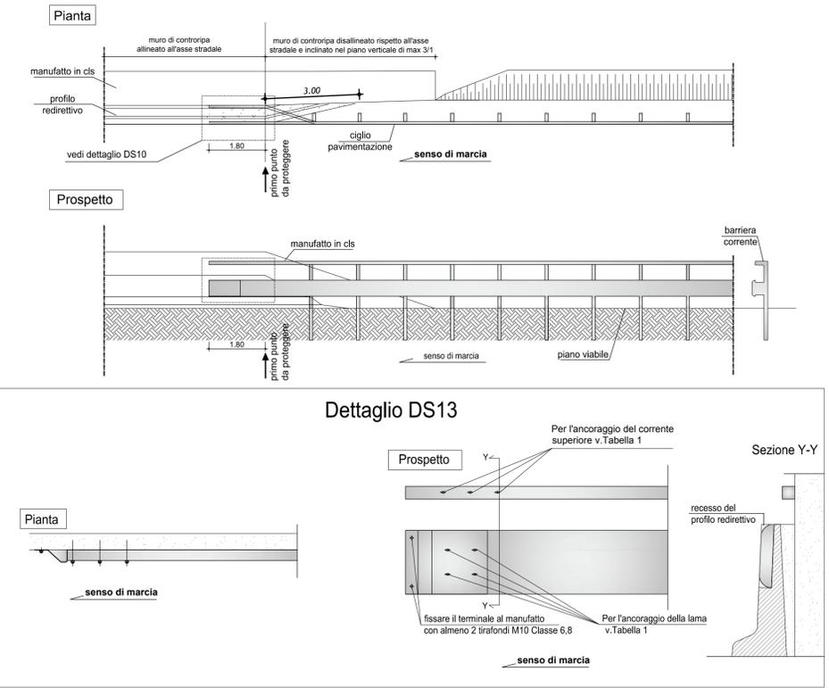
**SCHEMA S14: ANCORAGGIO DELLA BARRIERA DA BORDO LATERALE NEL TERMINALE DI AVVIO IMPIANTO**
