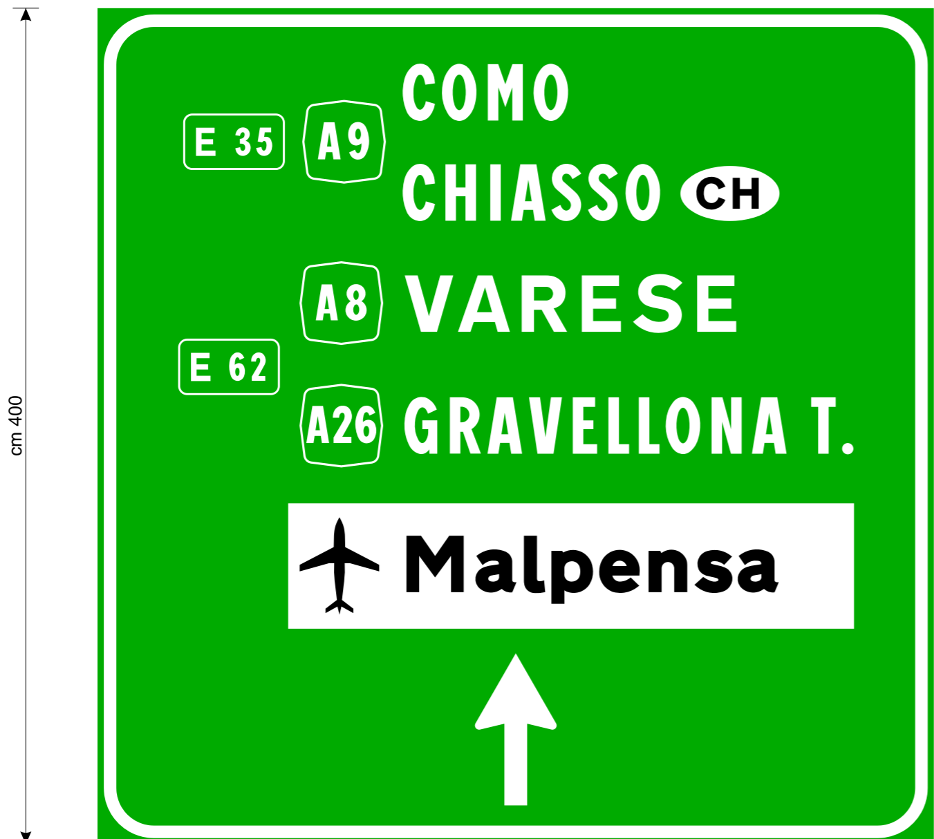
Targa in A30/10 con attacchi per barre di irrigidimento Pellicola fondo verde in pellicola classe 2, scritte, frecce e bordi bianchi in pellicola classe 2
