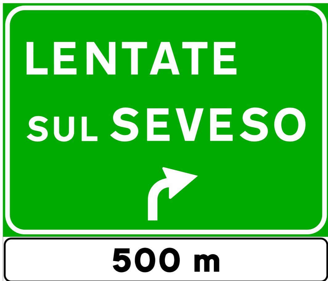
Targa in A30/10 con attacchi per barre di irrigidimento Pellicola fondo verde in pellicola classe 2, scritte, frecce e bordi bianchi in pellicola classe 2 Pannello integrativo fondo bianco in pellicola classe 2, scritte e bordo neri in pellicola n.r.
