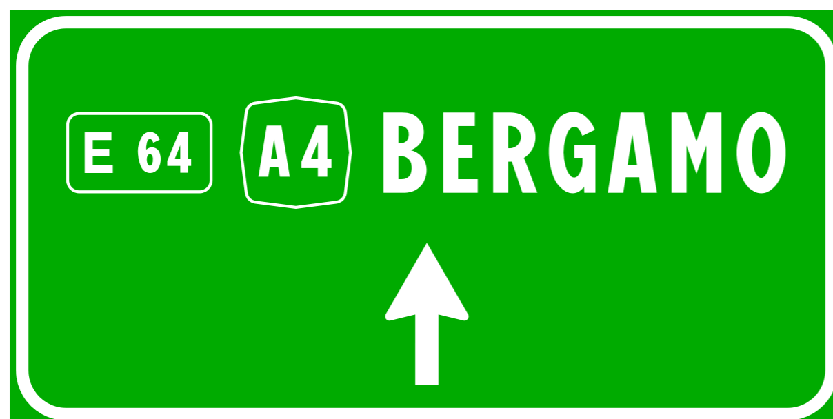
Targa in A30/10 con attacchi per barre di irrigidimento Pellicola fondo verde in pellicola classe 2, scritte, frecce e bordi bianchi in pellicola classe 2
