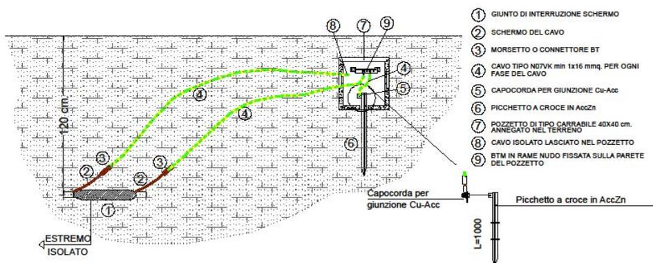
Infine, in corrispondenza di ogni buca giunti, per le terne di cavi unipolari non avvolti ad elica visibile, sarà eseguita la trasposizione delle fasi.
