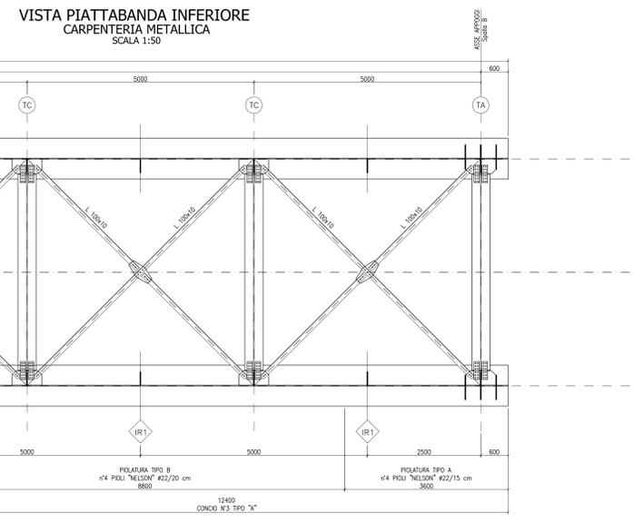
**SEZIONE LONGITUDINALE CARPENTERIA METALLICA SCALA 1:50**
