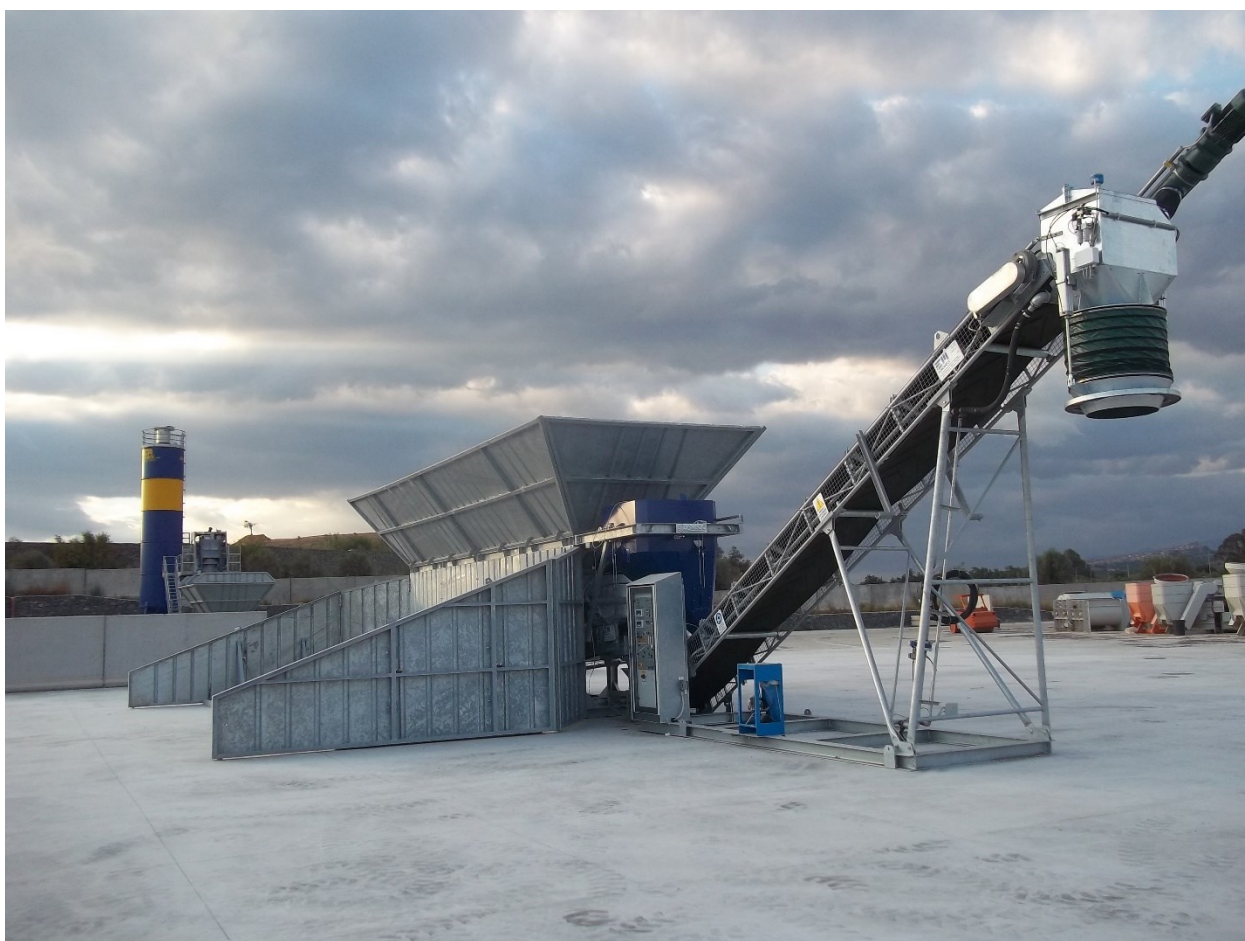
Figura 7 – Foto di un impianto di betonaggio semovente in esercizio
