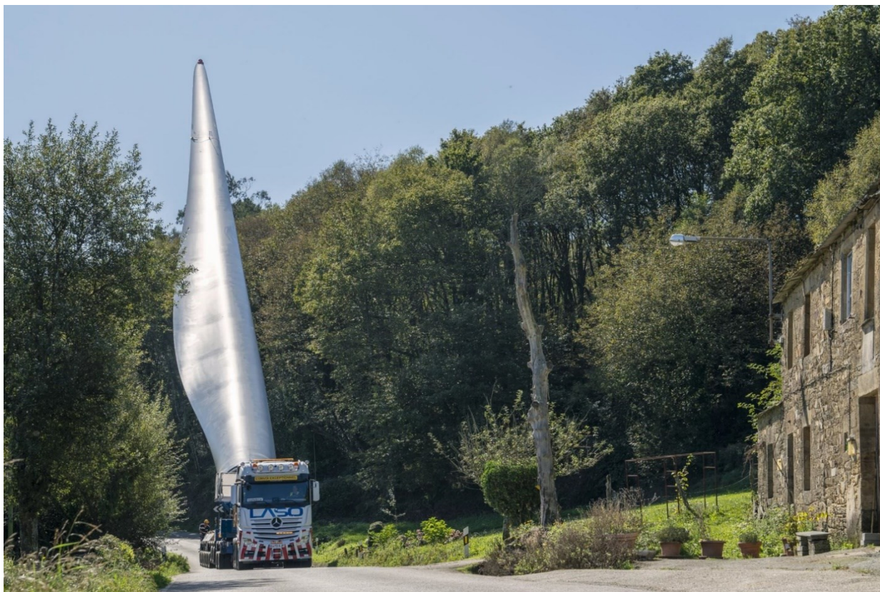
Figura 3 – Blade lifter, utilizzato per il trasporto di pale per aerogeneratori
