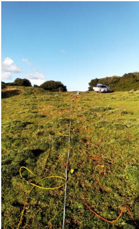
WTG005-Stendimento R3/M3 dal geofono 1
