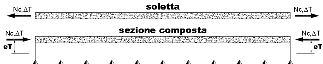
Figura 2-3 - Azioni statiche equivalenti alla variazione termica negativa
