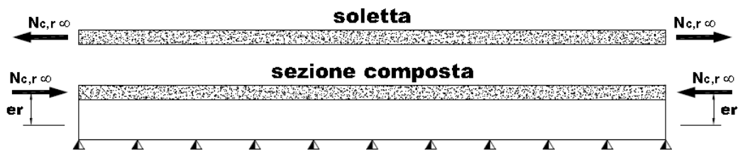
Figura 2-1- Azioni statiche equivalenti al ritiro
