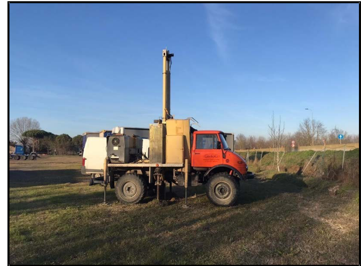
Foto n.37: Esecuzione prova CPTU3
