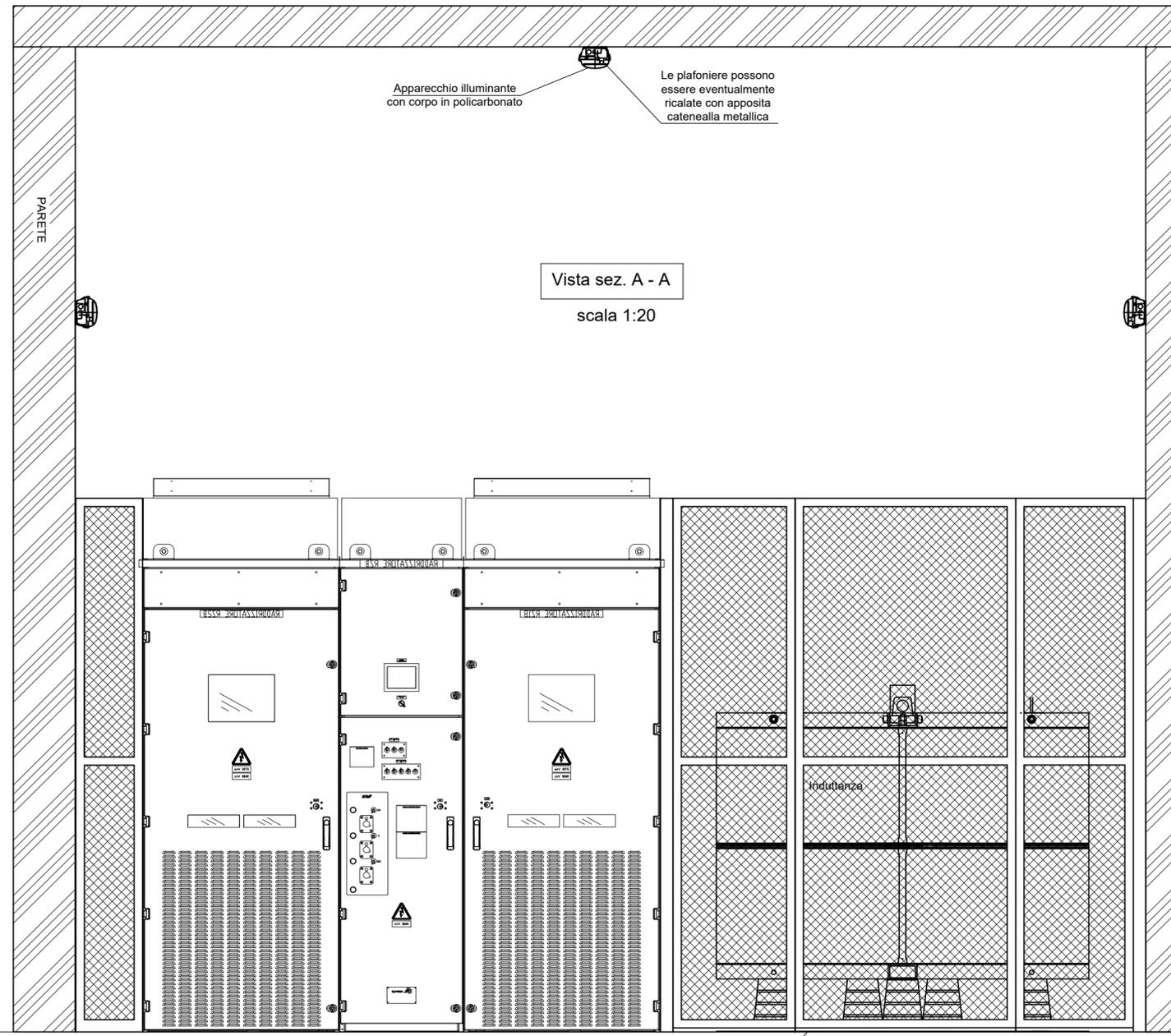
pannelli isolanti in VTR di sp. 3mm
