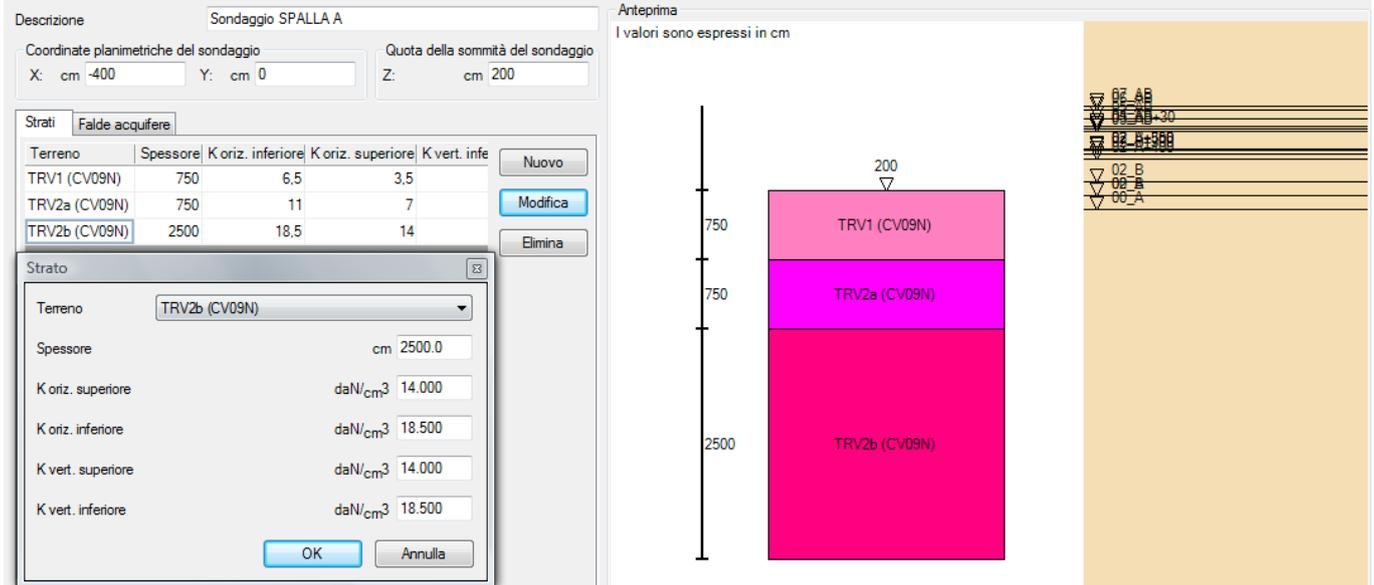
5.1.4.4 Sondaggio Spalla B - terreno TRV1
