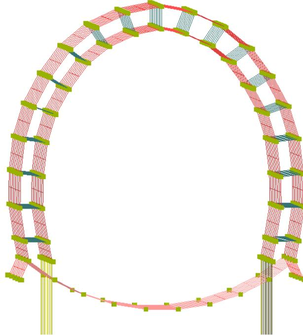
Fig.16\_Modello di calcolo: Vista prospettica, elementi shell e elementi link rigido
