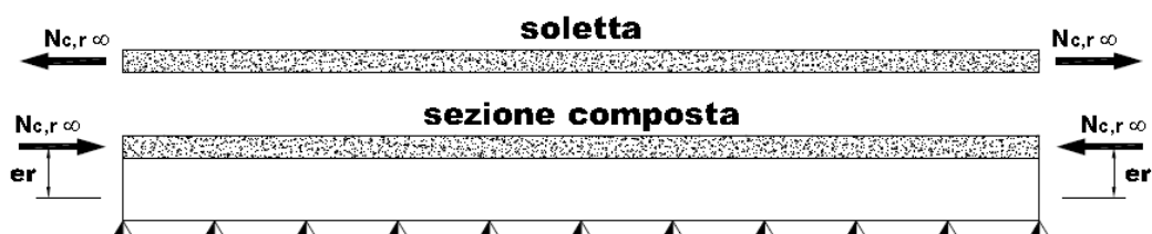
Figura 2-1- Azioni statiche equivalenti al ritiro
