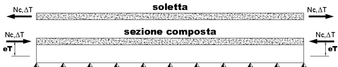
Figura 2-3 - Azioni statiche equivalenti alla variazione termica negativa
