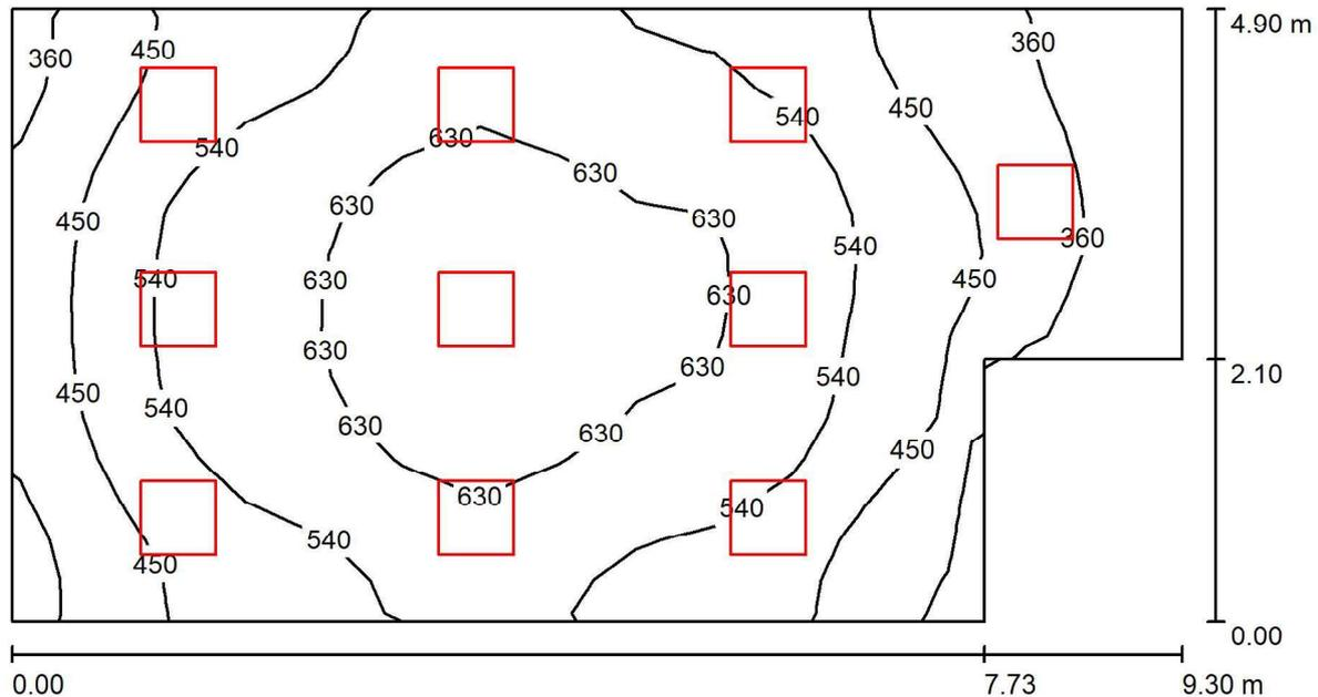
Altezza locale: 5.300 m, Altezza di montaggio: 5.300 m, Fattore di manutenzione: 0.80
