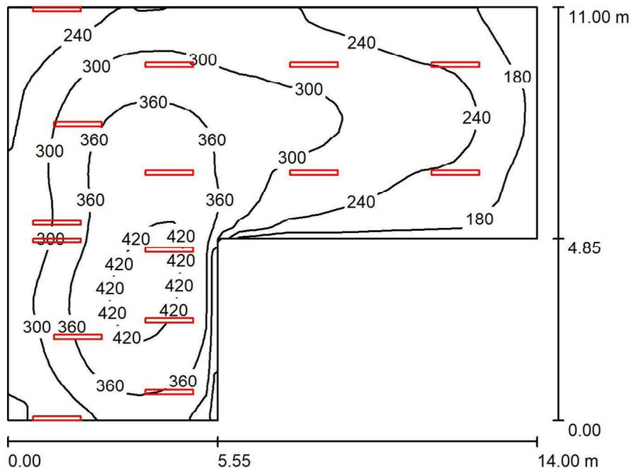
Altezza locale: 4.500 m, Altezza di montaggio: 4.500 m, Fattore di manutenzione: 0.80
