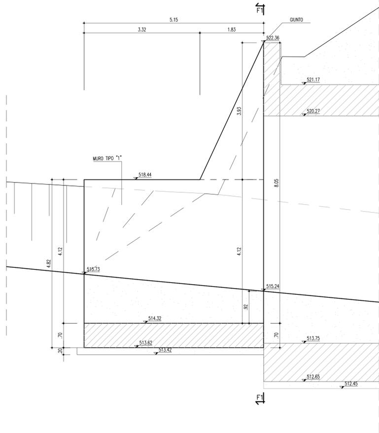
MURO TIPO 1 (SEZIONE F1-F1)
