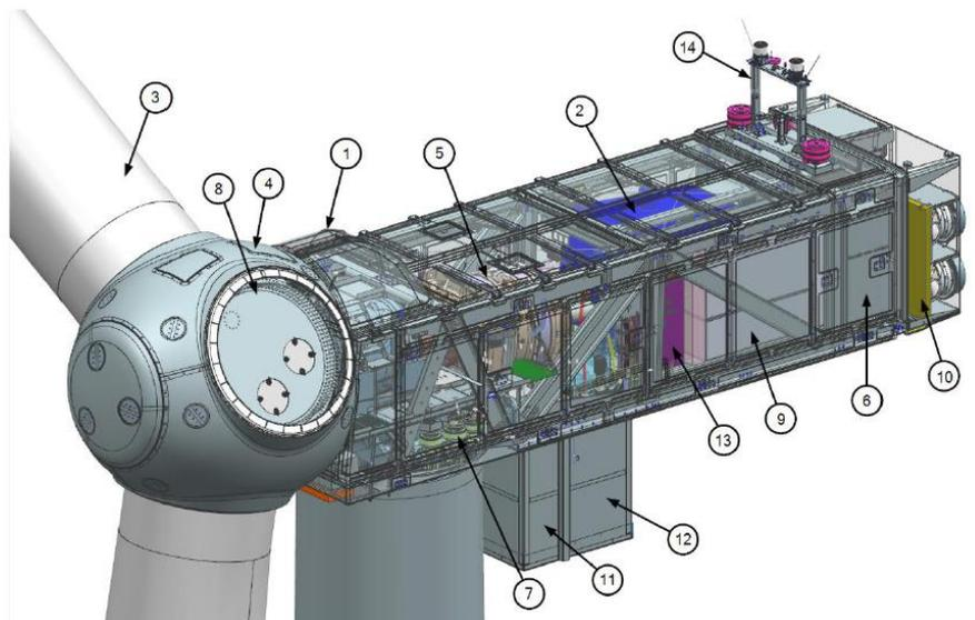
**Figura 1 schema descrittivo della navicella Siemens Gamesa SG 6.0-155**
