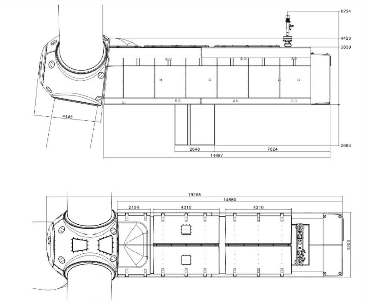
**Figura 3: Dimensioni della navicella SG 6.6-155**
