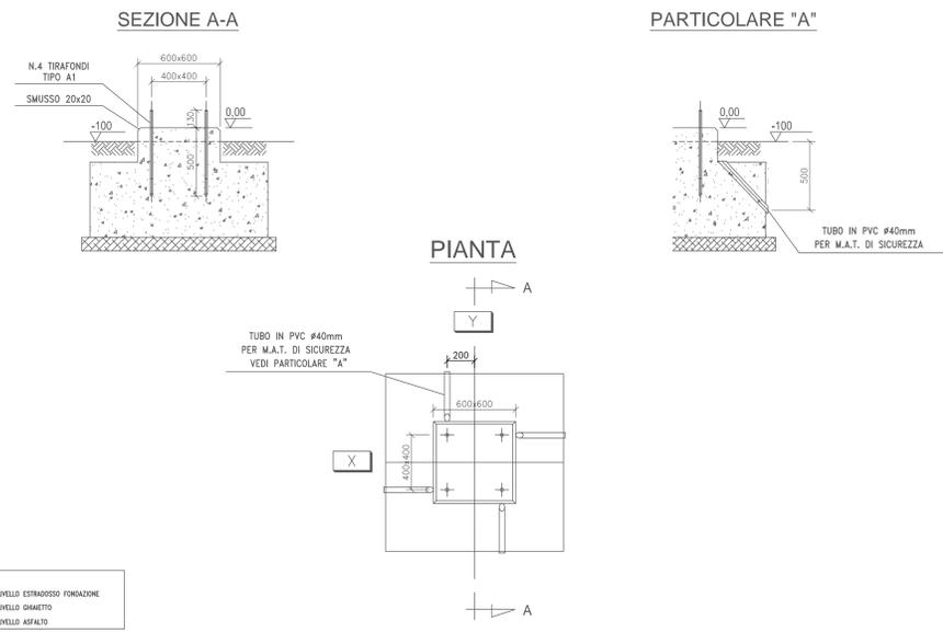
FONDAZIONE PER SUPPORTO SBARRE TRIPOLARE
