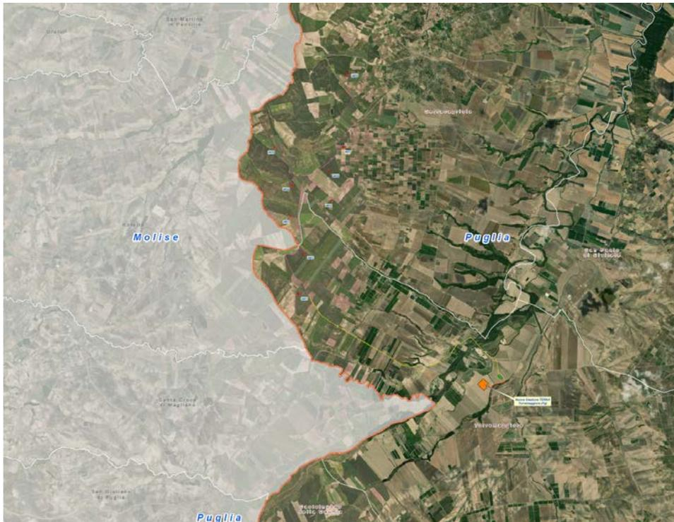
Figura 1: Inquadramento dell'area di realizzazione dell'impianto di 9 aerogeneratori per una potenza complessiva di 50 MW in agro dei comuni di Serracapriola e Torremaggiore.
