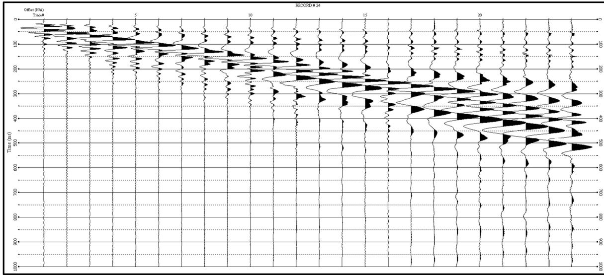
Sismogramma analisi Masw-offset 4 metri
