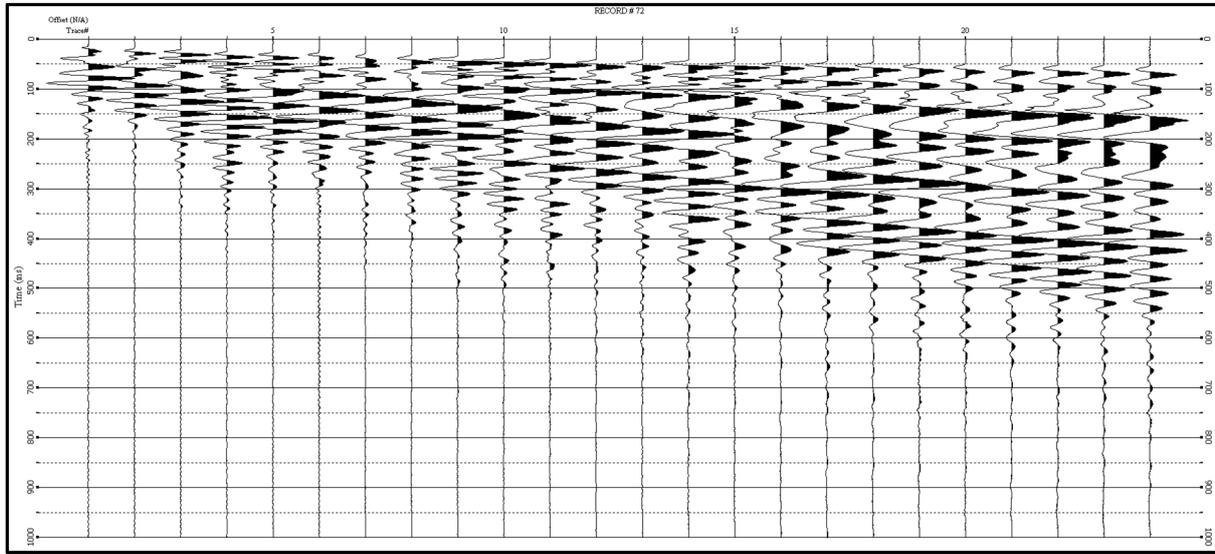
Sismogramma analisi Masw-offset 4 metri
