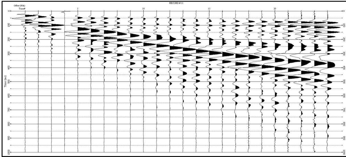
Sismogramma analisi Masw-offset 4 metri
