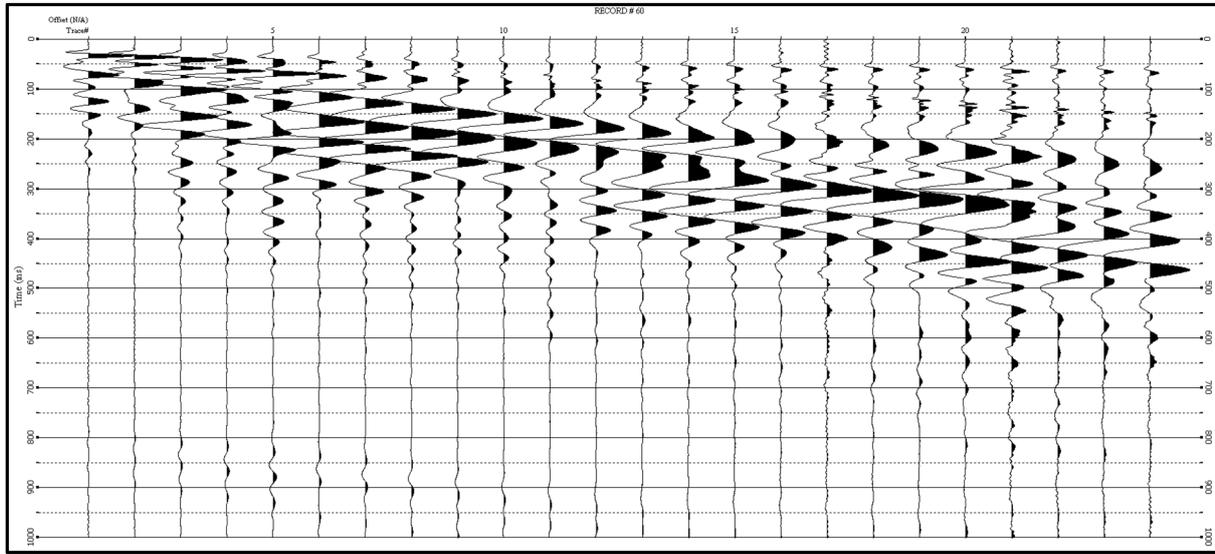
Sismogramma analisi Masw-offset 4 metri
