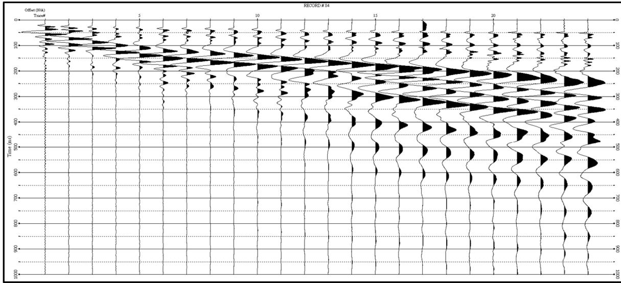
Sismogramma analisi Masw-offset 4 metri
