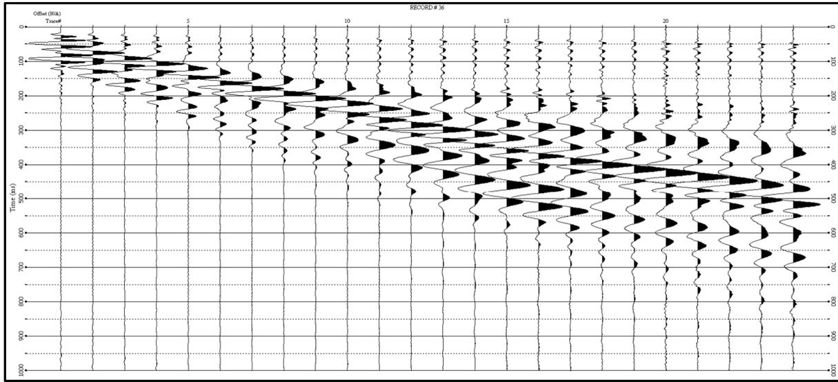
Sismogramma analisi Masw-offset 4 metri
