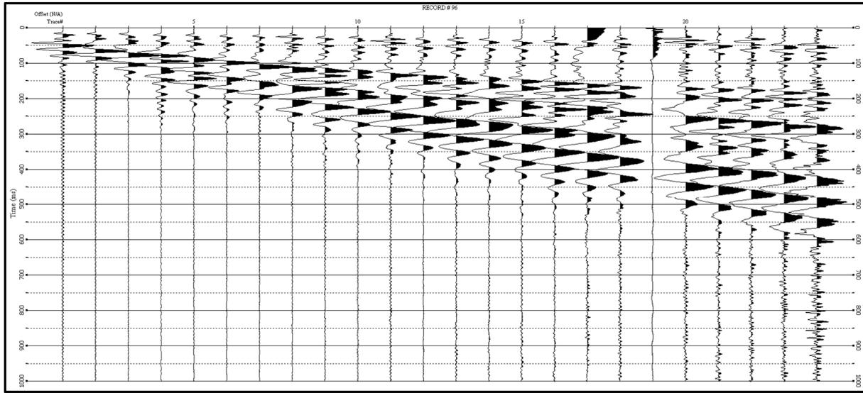
Sismogramma analisi Masw-offset 4 metri
