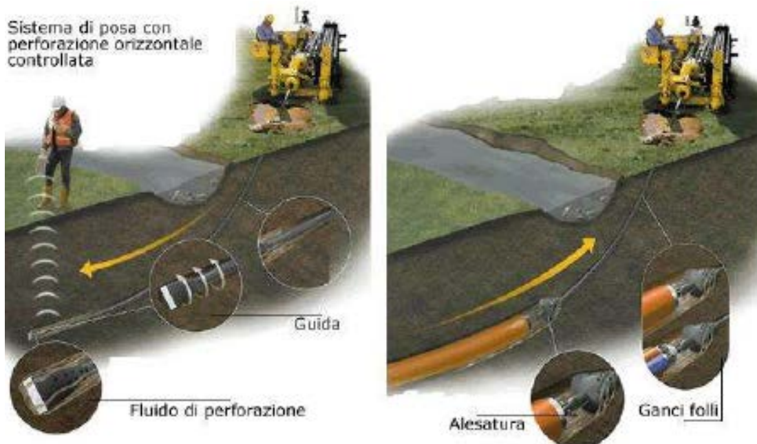
Posa in opera tubazione con trivellazione teleguidata
