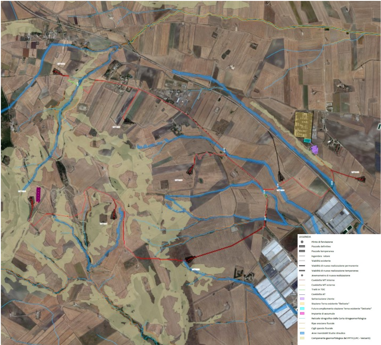
Percorso del cavidotto con interferenze
