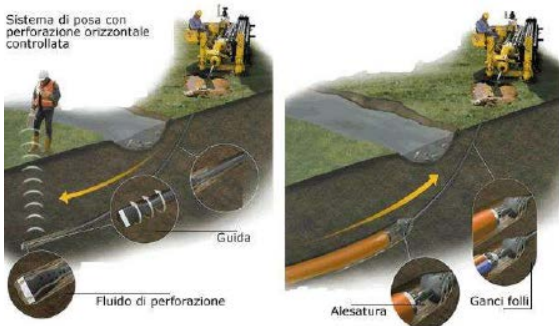
Posa in opera tubazione con trivellazione teleguidata
