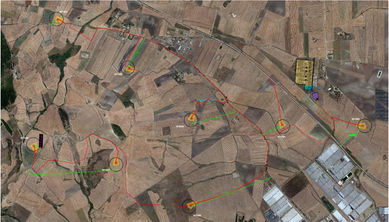
Distanza dalle strade (in verde) degli aerogeneratori
