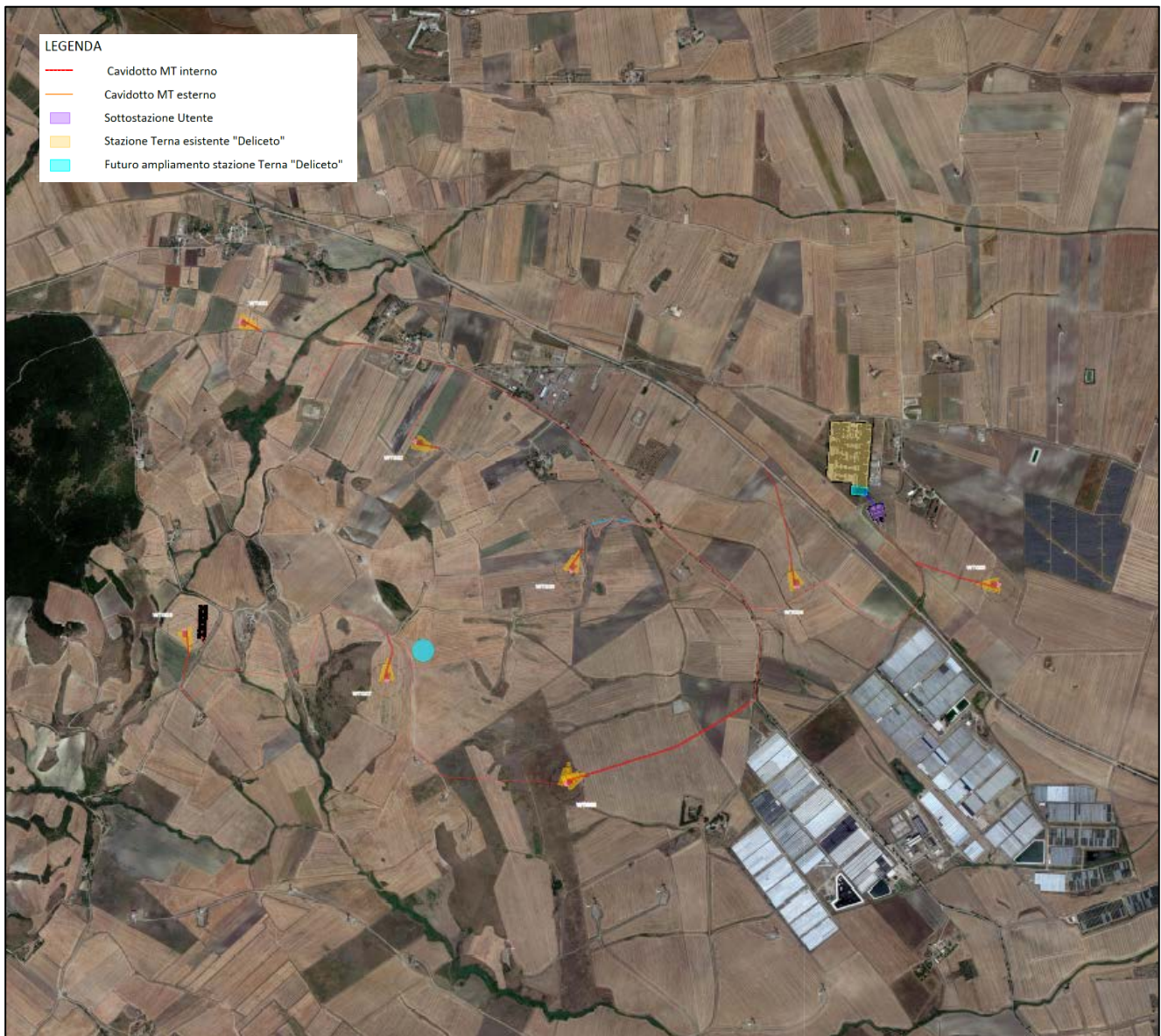
Tav.4: Percorso del cavidotto su ortofoto
