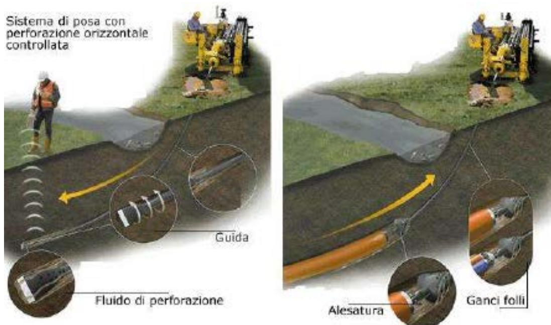
Posa in opera tubazione con trivellazione teleguidata
