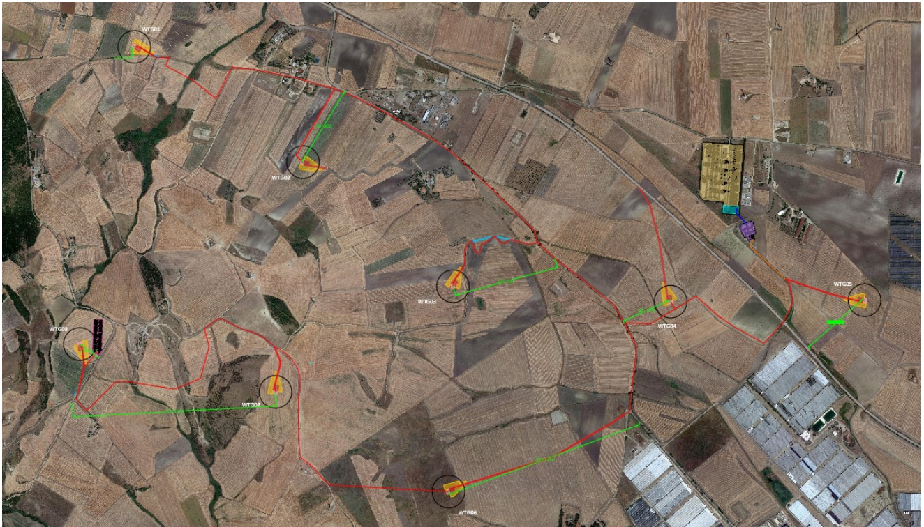
Distanza dalle strade (in verde) degli aerogeneratori
