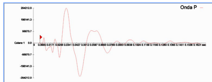
Fig. 2.1.2 - Esempio di onda P e di lettura del primo tempo di arrivo.
