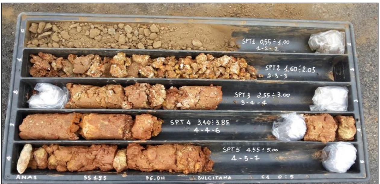
Foto 2 - Terre rimaneggiati estratti dal sondaggio S06_DH, intervallo di profondità 0,06÷9,00 m.
