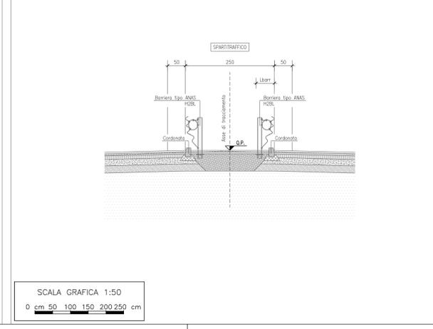
PARTICOLARE ELEMENTO MARGINALE SU VIABILITA' SECONDARIA CON SEZIONE IN RILEVATO
