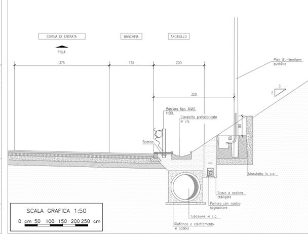
PARTICOLARE ELEMENTO MARGINALE CON BORDURA IN CORRISPONDENZA DEL PALO LUCE CON COLLETTORE Ø 1000 E POZZETTO DI ISPEZIONE
