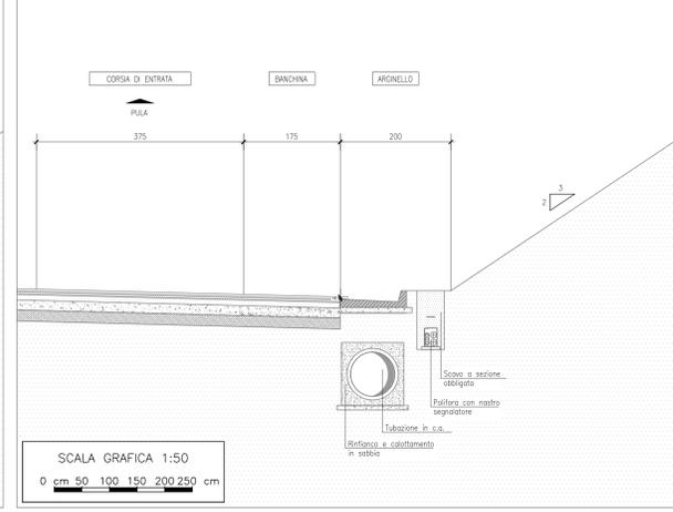
PARTICOLARE ELEMENTO MARGINALE SU VIABILITA' PRINCIPALE CON SEZIONE IN RILEVATO E PALO ILLUMINAZIONE
