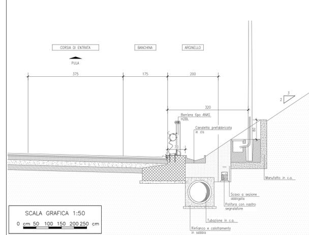
PARTICOLARE ELEMENTO MARGINALE CON CORDOLO IN CORRISPONDENZA DEL CAVALCAVIA CON COLLETTORE Ø 800
