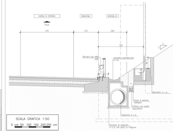
PARTICOLARE ELEMENTO MARGINALE CON CORDOLO IN CORRISPONDENZA DEL PALO LUCE CON COLLETTORE Ø 800
