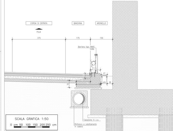
PARTICOLARE ELEMENTO MARGINALE CON CORDOLO IN CORRISPONDENZA DEL POZZETTO DI ISPEZIONE
