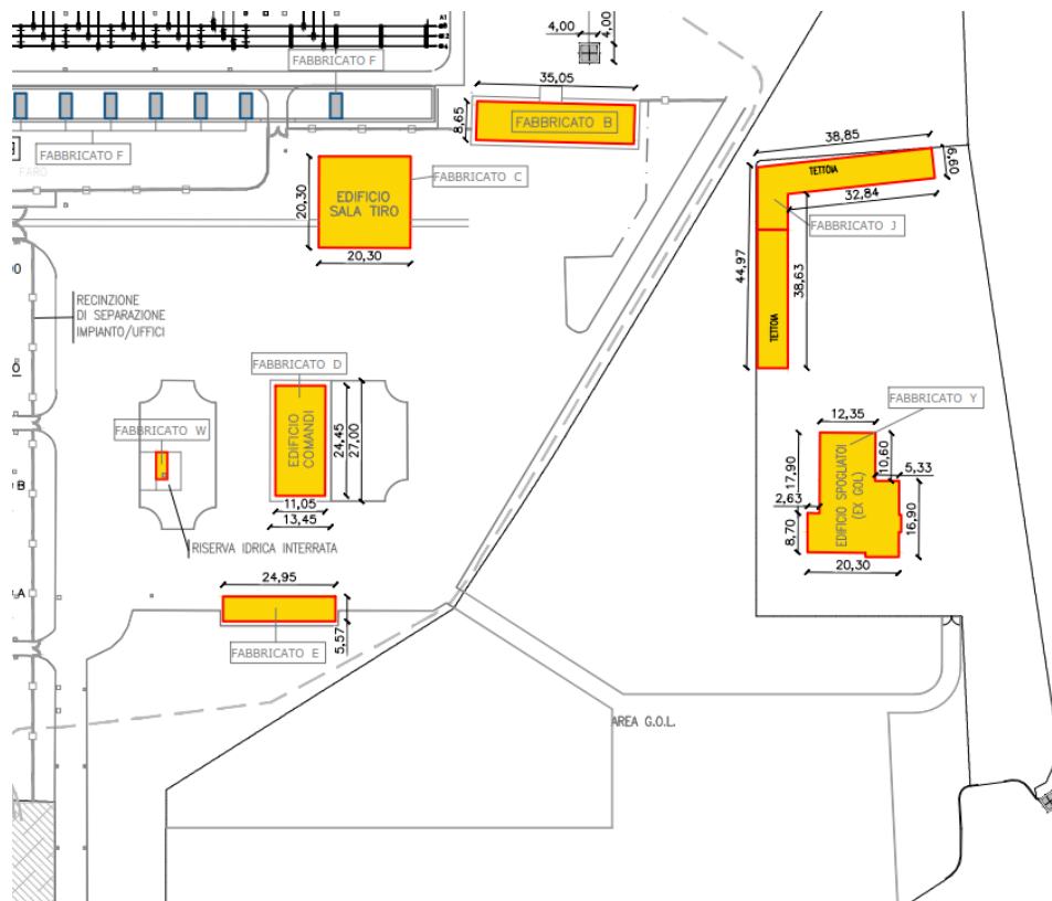
Figura 2.21: Edifici da demolire all'interno della stazione di conversione esistente
