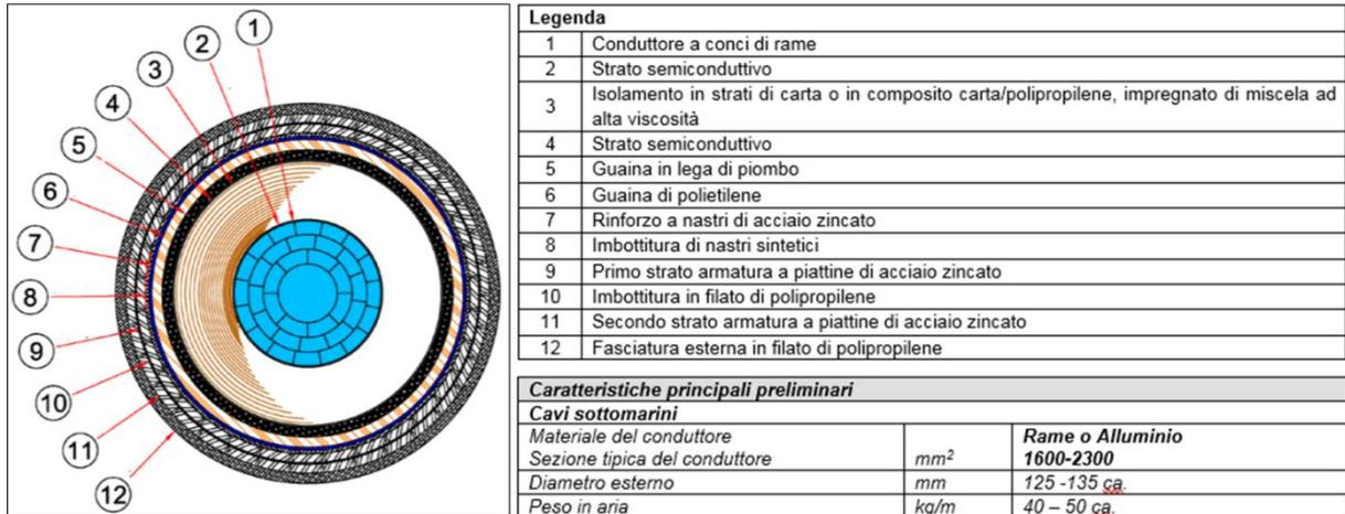
Figura 3.3: Dimensioni e caratteristiche dei cavi di polo (caratteristiche indicative)
