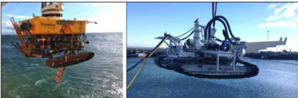
**Figura 5.9: Esempio di macchina per jetting su cingolato**
