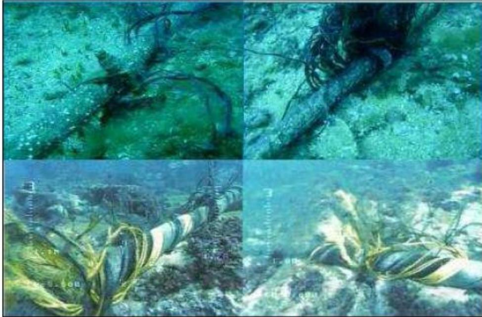
**Figura 5.1: Esempi di cavi sottomarini danneggiati in assenza di protezioni per effetto di attività antropiche**
