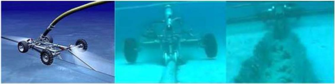
**Figura 5.8: Esempio di macchina per jetting autopropulse**
