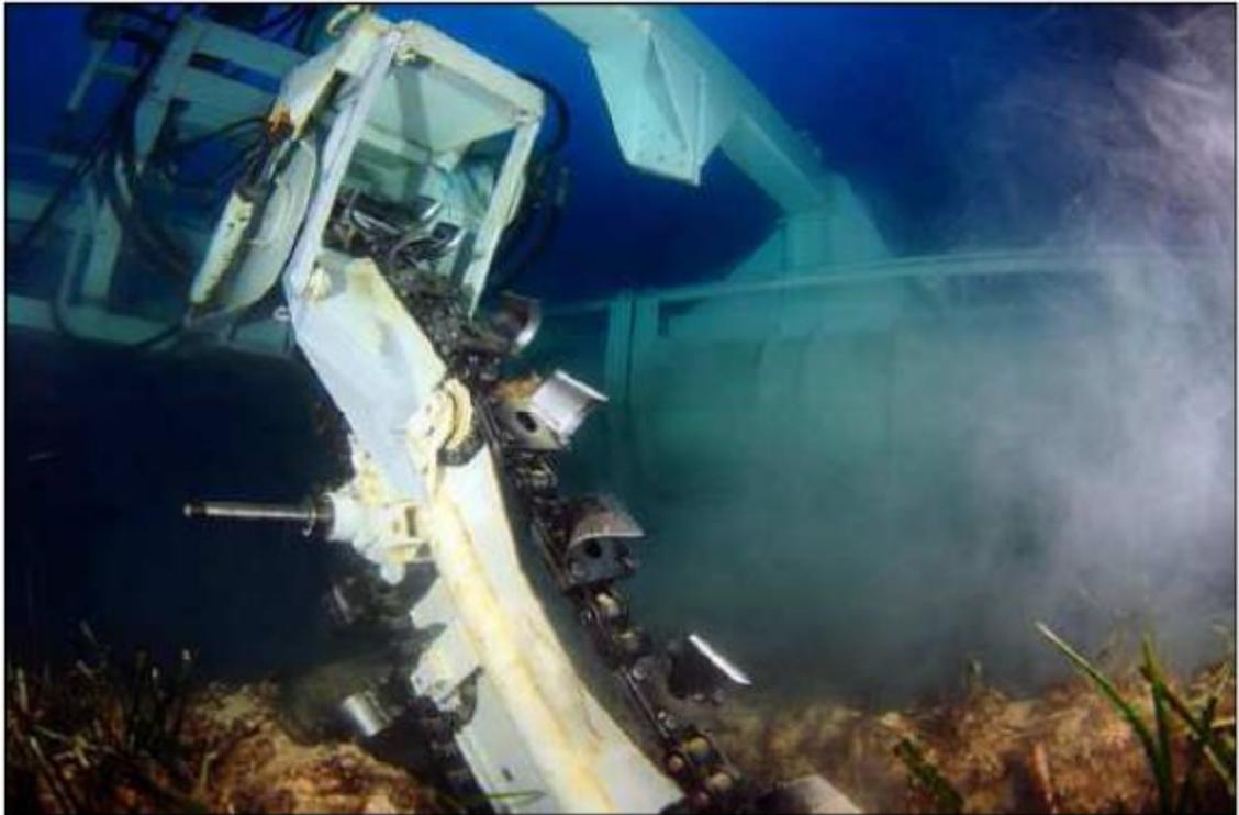
**Figura 5.14: Esempio di utensile di taglio per una macchina per il trenching**
