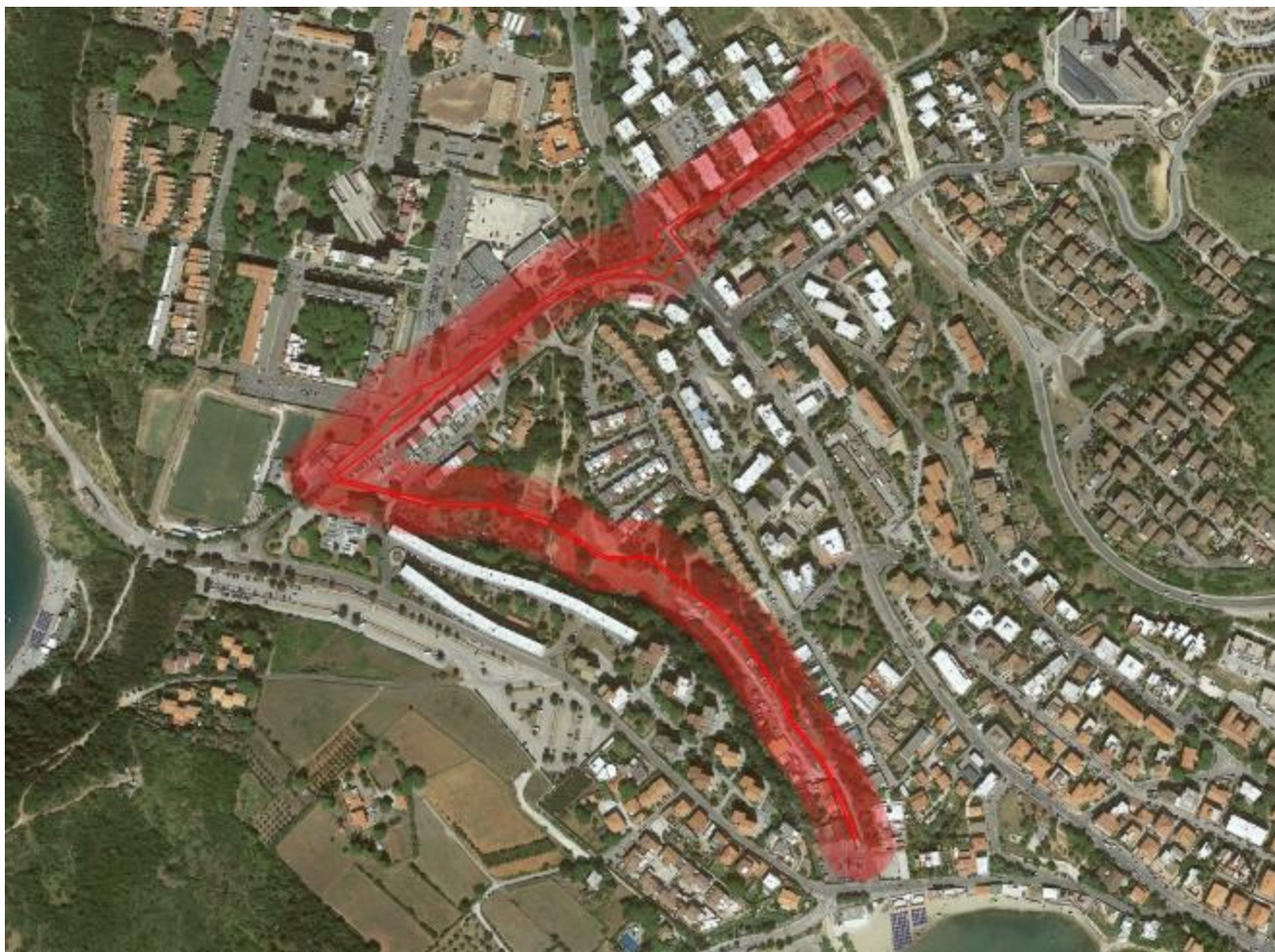
Figura 11.19: Area lungo il tracciato del cavidotto in cui il livello di pressione sonora supera i 70 dB(A)
