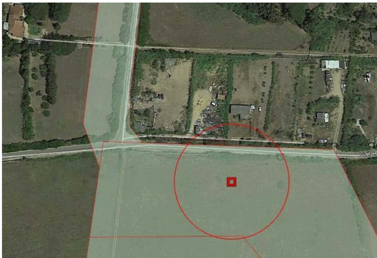
Figura 11.16: Area intorno al punto di transizione in cui il livello di pressione sonora supera i 70 dB(A)
