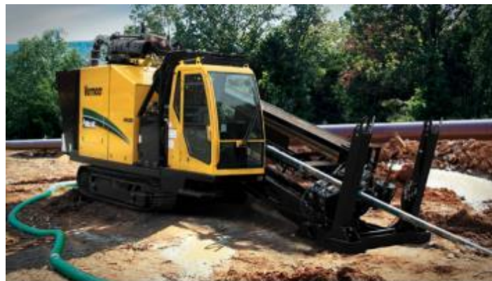
Figura 11.13: Esempio di macchina perforatrice per TOC
