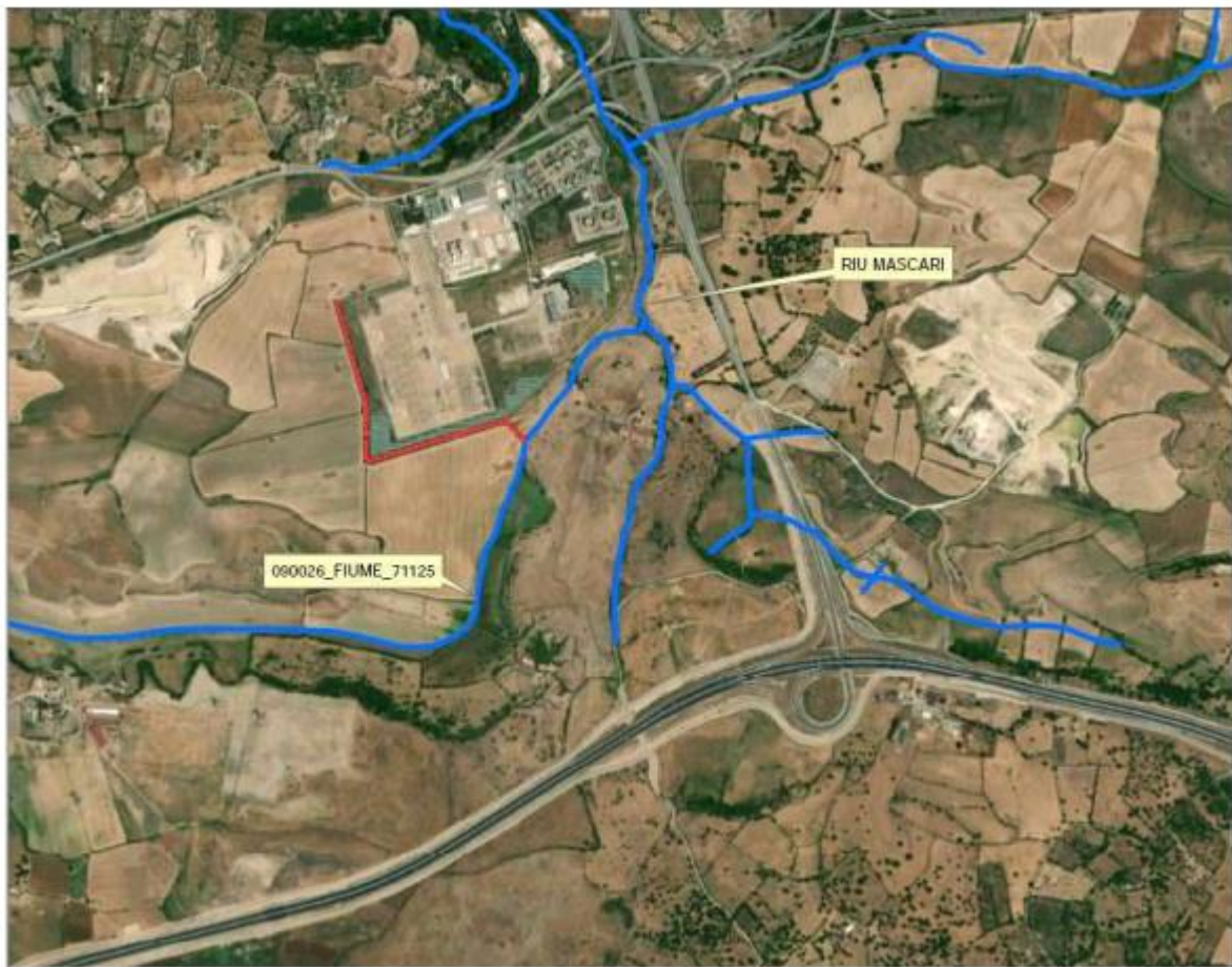
Figura 2.2: Reticolo idrografico nell'area della stazione elettrica (in blu) e canale di drenaggio progettato per la regimazione delle acque a monte della stessa stazione (in rosso) (l'intervento non fa parte del progetto SA.CO.I. 3).
