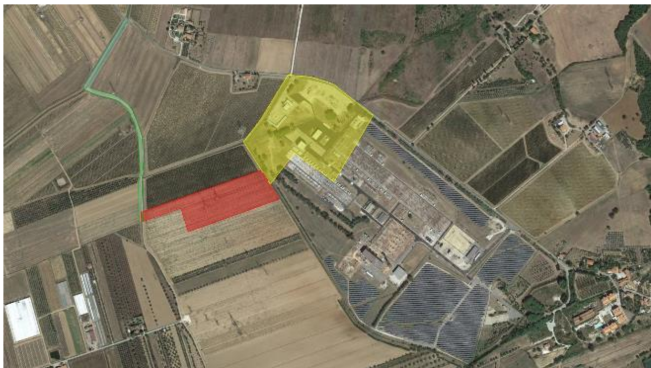
Figura 11.20: Area di cantiere (in rosso) ed area di lavoro (in giallo) per la realizzazione della nuova stazione elettrica di conversione di Suvereto
