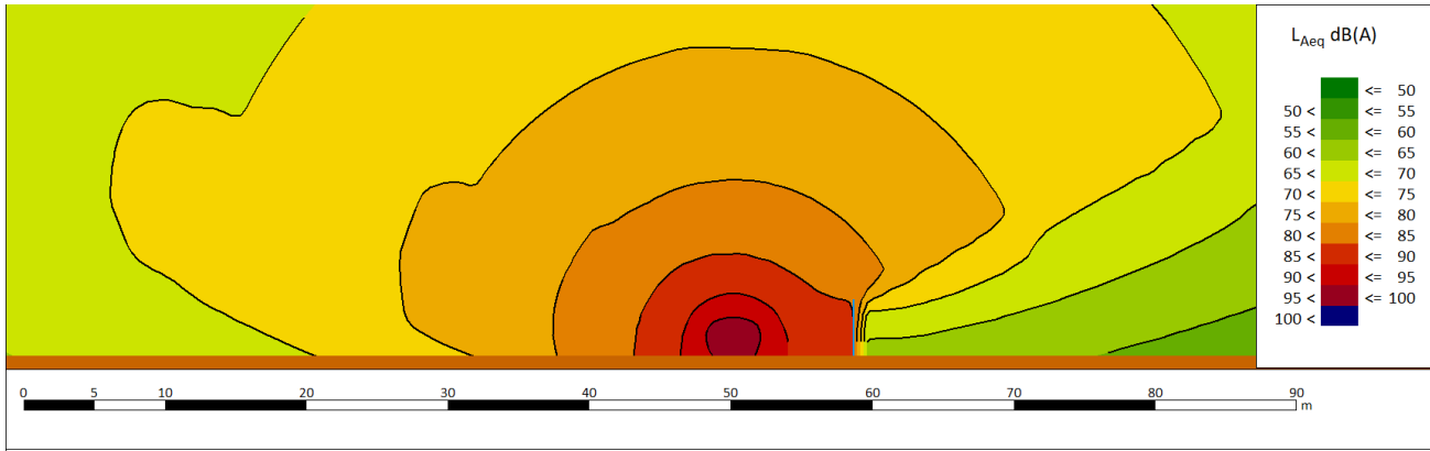
Figura 11.24: Mitigazione dell’impatto acustico generato dalle lavorazioni per la TOC tramite barriera antirumore di cantiere
