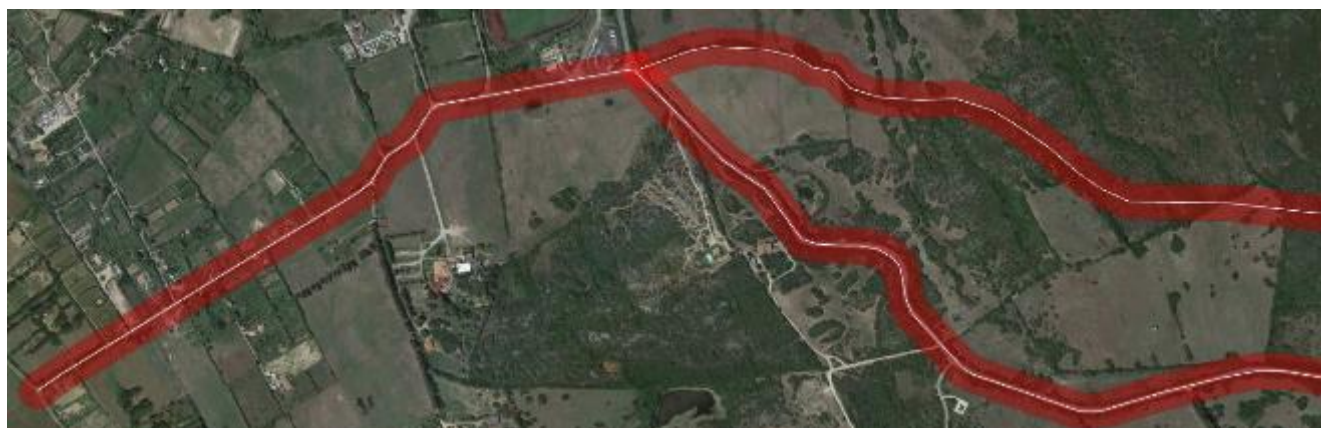
Figura 11.15: Area lungo il tracciato del cavidotto in cui il livello di pressione sonora supera i 70 dB(A)
