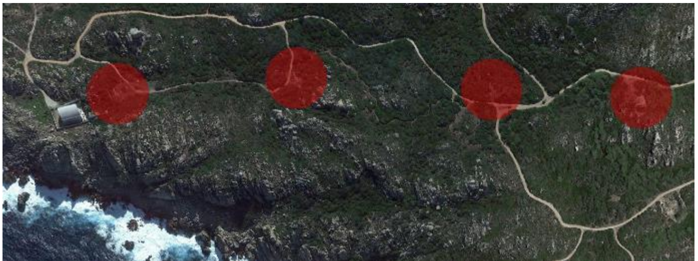
Figura 11.17: Area intorno ai sostegni da demolire in cui il livello di pressione sonora supera i 70 dB(A)
