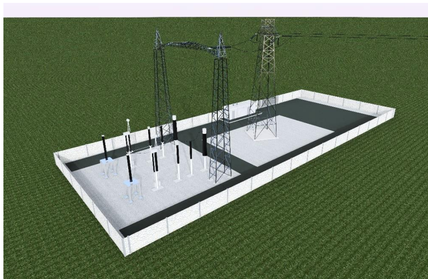
Figura 4.4: Punto di sezionamento e transizione aereo cavo da realizzare in località Buoncammino
