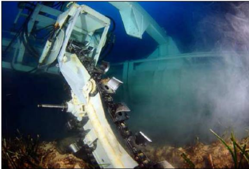
Figura 4.21: Esempio di macchina per lo scavo tramite fresa
