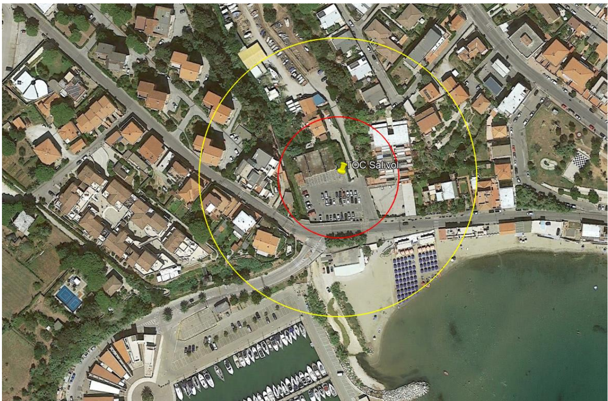
Figura 7.12: Aree di impatto acustico per la realizzazione della perforazione TOC a Salivoli: aree in cui il livello di pressione sonora supera i 70 dB(A) (in rosso) e i 60 dB(A) (in giallo)
