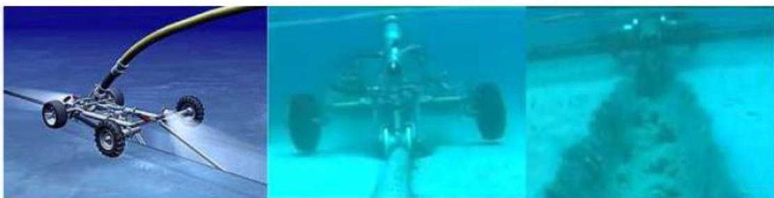
Figura 4.22: Esempio di macchina per scavo tramite getto d'acqua (jetting)
