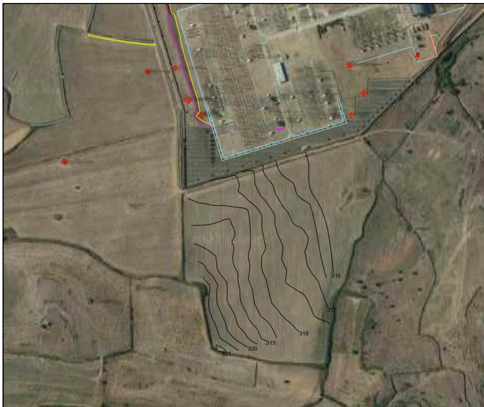
Ortofoto con curve di livello elaborate dalla restituzione del rilievo GNSS presso l'area interessata dal progetto
