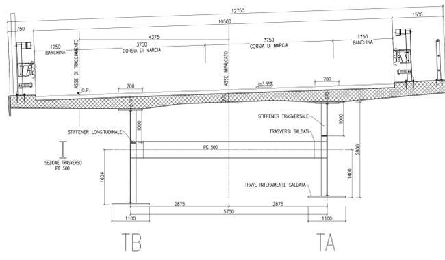
**SEZIONE TRASVERSALE IN ASSE APOGGIO**
