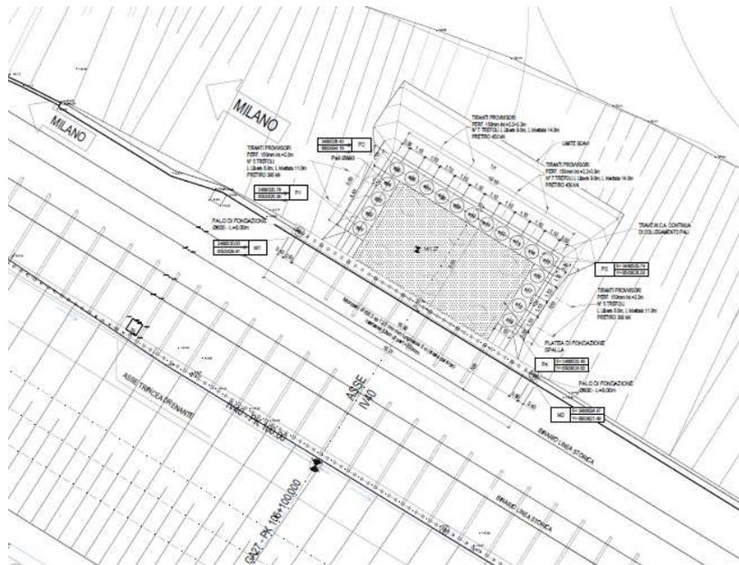
Figura 2. Pianta di inquadramento delle opere di sostegno
