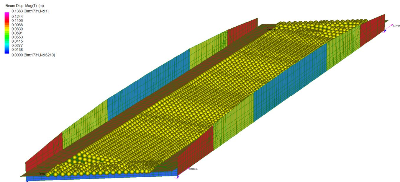
Si ottiene quindi uno spostamento diretto parallelamente all'asse trave pari a 14.5cm (somma di spostamento sismico e termico) e trasversale di 4.5cm. Quindi misurando la distanza ortogonalmente all'asse del traverso di spalla è necessario lasciare un varco pari a 17cm e prevedere un giunto da  $\pm 16\text{cm}$ .
