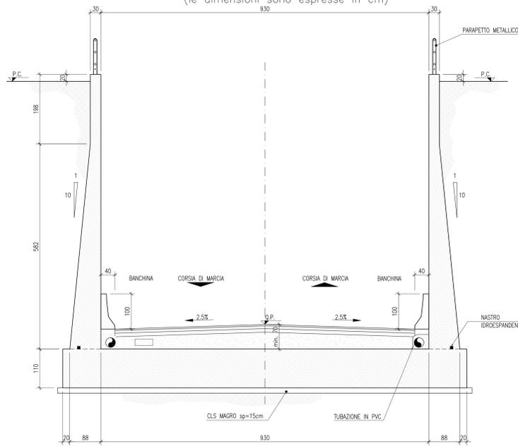
SEZIONE TIPO IN RILEVATO (H < 1.50 m) 1:50
