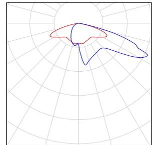
Flusso luminoso lampadine complessivo: 7380 lm, Flusso luminoso lampade complessivo: 7380 lm, Potenza totale: 61.0 W, Rendimento luminoso: 121.0 lm/W
