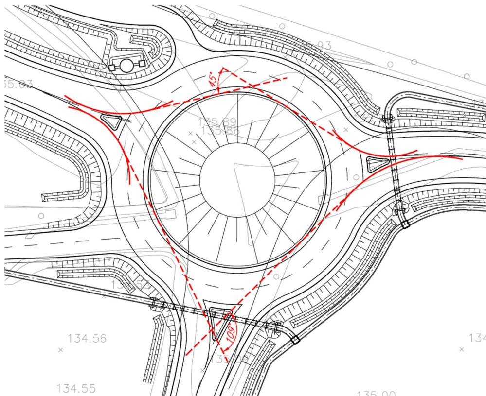
*Rotatoria Sud. Schema grafico delle verifiche di deflessione (da D.Lgs. 19 aprile 2006 - Norme funzionali e geometriche per la costruzione delle intersezioni stradali).*
