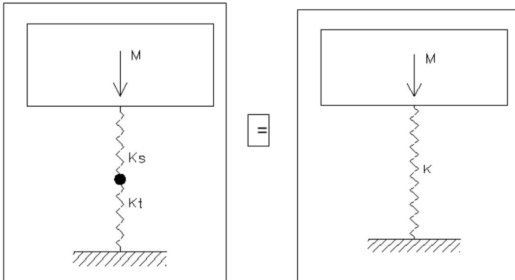
Detta  $K_{eq}$  la rigidità del sistema equivalente, essa si determina con la relazione
